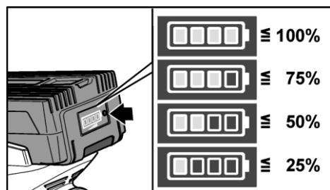
Se um dos LEDs piscar, a bateria deve ser recarregada. Se nenhum dos LEDs acender após o botão ser pressionado, a bateria está com defeito e deve ser substituída.
