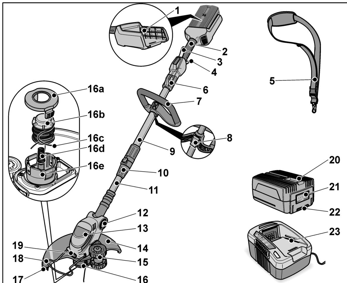
1 local de inserção para bateria - 2 alça - 3 Interruptor de intertravamento - 4 interruptor de ligar / desligar - 5 cinto de ombro - 6 laço de fixação para cinto de ombro - 7 guiador
